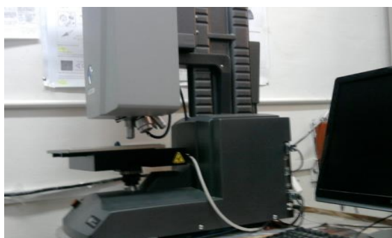
Fig.3. : Microscope utilisé pour la mesure de l'épaisseur de la couche mince
